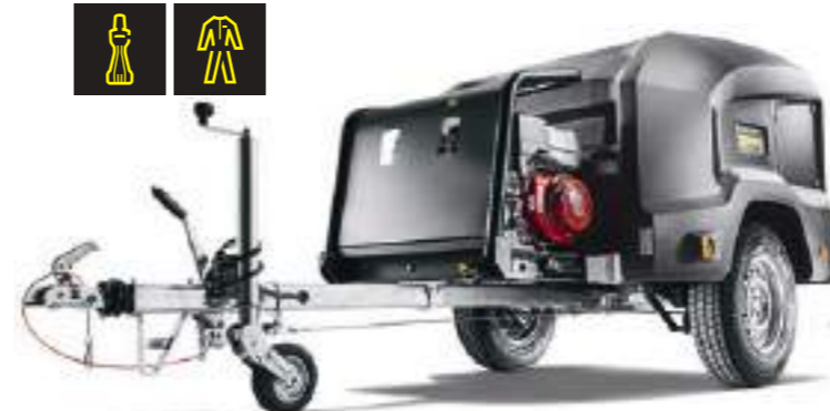
Koudwater hogedruktrailer HD 9/23 Ge Artnr. 1.524-954.2 ■ Brandstof: GX 390/benzine ■ Wateropbrengst: 400-930 l/u ■ Werkdruk: 40-230 bar
