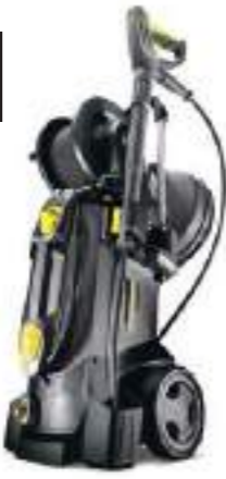
Koudwater hogedrukreiniger HD 5/15 CX Plus + FR Classic Artnr. 1.520-934.0 ■ Stroomsoort: 230 V-1~ ■ Wateropbrengst: 500 l/u ■ Werkdruk: 150 bar ■ Inclusief oppervlaktereiner
